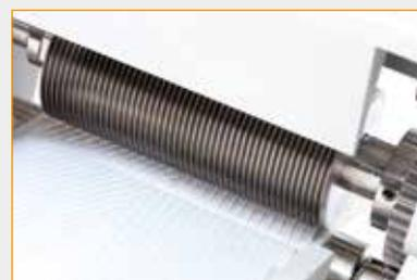
Diferentemente da maioria dos Expansores convencionais, em que o condutor é movido através do dispositivo por meio de puxar intermitentemente uma catraca, o Expansor Humeca® é acionado pela rotação contínua de uma alavanca. A rotação torna o procedimento de malha menos demorado e o design é muito mais ergonômico. A abertura da ponte do Expansor permite fácil acesso ao eixo de corte para limpeza e inspeção.
